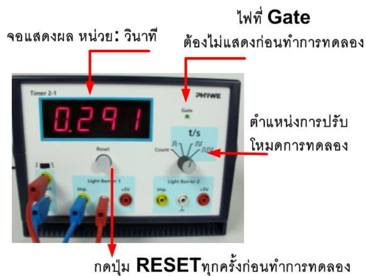
รูปที่ 5 การจัดอุปกรณ์ทดลองการตกอย่างอิสระ
